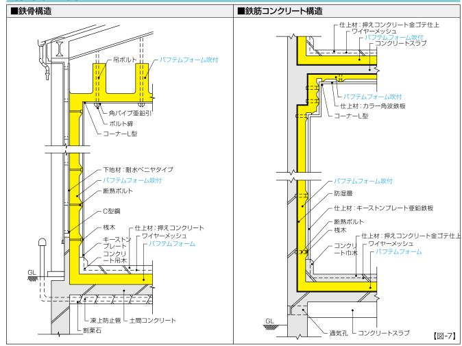
※施工厚さ80mm以上の場合はエキスパンション又はクロス金網等の補強芯材埋め込み構造とする。
